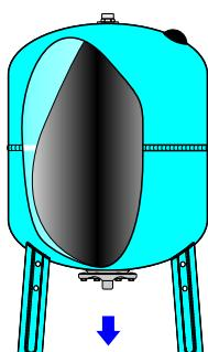
Quando la pressione dell'impianto raggiunge il valore di soglia massima impostata la pompa si arresta. Nel vaso vi è la quantità massima d'acqua accumulabile. Naturalmente la membrana si è dilatata ed occupa la quasi totalità del volume interno del vaso. Se richiamata dall'impianto l'acqua comincia ad uscire senza l'aiuto della pompa sfruttando la pressione dell'aria della camera pressurizzata.
