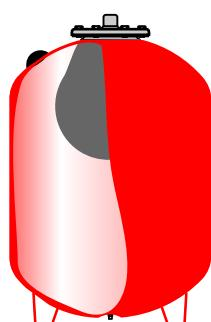
Gradualmente la temperatura dell'impianto inizia a scendere e con essa il volume dell'acqua, il vaso cede ora l'acqua all'impianto grazie alla pressione dell'aria della camera pressurizzata sino al raggiungimento del volume iniziale ed il ciclo si riavvia.
