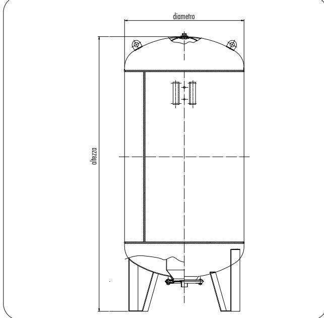
**Utilizzo:** Vaso di espansione con membrana intercambiabile per circuiti chiusi di riscaldamento.
