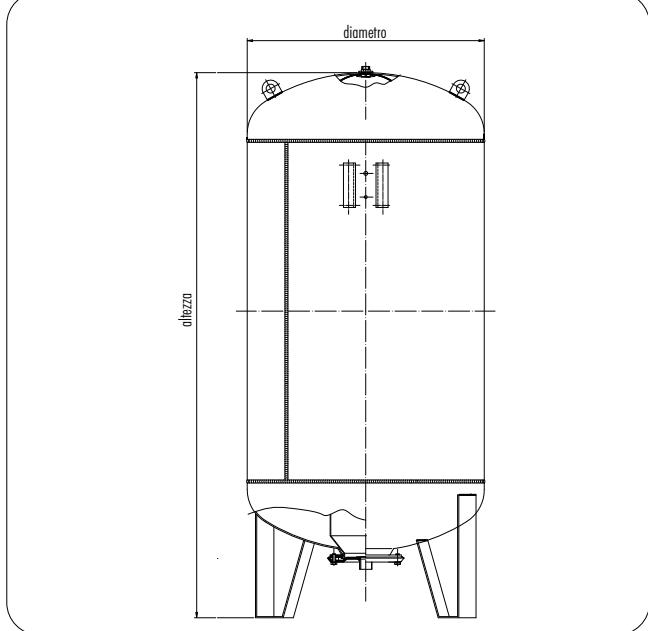
**Utilizzo:** Vaso autoclave con membrana intercambiabile per circuiti di acqua sanitaria.
