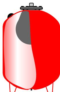
Tutti i vasi della serie VR (VRV, VS e VSV) escono dalla fabbrica controllati, verificati e certificati. Una volta connesso al circuito a cui è destinato, all'aumentare della temperatura, aumenta il volume dell'acqua che espandendosi comincia a riempire la membrana.
