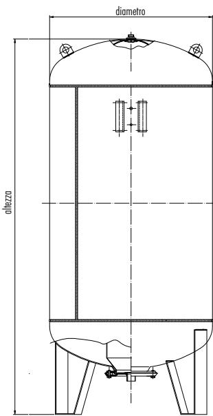
**Utilizzo:** Vaso autoclave con membrana intercambiabile per circuiti di acqua sanitaria.
