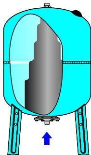
Tutti i vasi "acqua fredda" escono dalla fabbrica controllati, verificati e certificati. La membrana intercambiabile evita qualunque contatto tra aria ed acqua impedendo ogni possibile perdita di pressione, contaminazione e corrosione. Una volta connesso al circuito a cui è destinato, la pompa parte facendo aumentare la pressione dell'impianto, facendo entrare l'acqua nella membrana.
