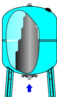
Si prosegue con l'erogazione di acqua all'impianto, la membrana si sgonfia, sino al raggiungimento della pressione di soglia minima dell'impianto. A questo punto, la membrana è ritornata alle dimensioni iniziali, la pompa si riavvia ed il ciclo si ripete. Poiché la gamma "acqua fredda" garantiscono in ogni istante la massima quantità di acqua possibile, le parenze della pompa sono ridotte al minimo.
